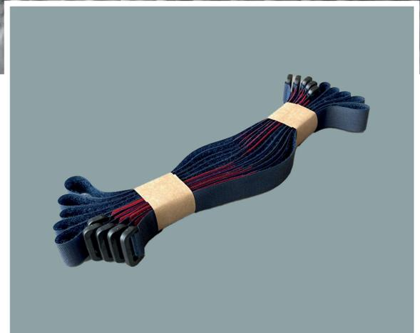
Die farbcodierten Ringgurte wurden speziell für Gipsräume entwickelt. Die Farbe des Hakenbereichs ermöglicht es dem Benutzer, die Größe sofort zu erkennen. Wie die normalen Ringgurte von GeniMedical bestehen auch diese Ringgurte aus gewebtem Polyamid. Ein großer Teil des Schlaufenbandes ist durch Ultraschall-Schweißen mit einem kleineren Teil des Hakenbandes verbunden. Das Ende des Hakenbereichs ist mit einem „Easy Peel“ ausgestattet, wodurch der Verschluss leicht geöffnet werden kann.
